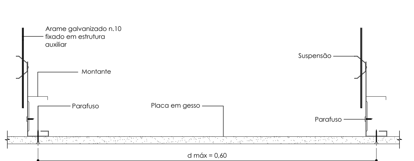
Forro Monolítico - Detalhe Genérico Corte Transversal Sem escala
