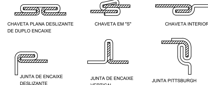
DETALHE 12: CONSTRUÇÕES PARA DUTOS CONVENCIONAIS DE CHAPA DE AÇO GALVANIZADA - BAIXA PRESSÃO SEM ESCALA
