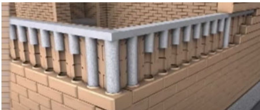
Figura 4: Detalhe da execução de contra-vergas em janelas
