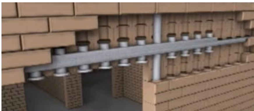
Figura 5: Detalhe da execução de vergas em portas e janelas
