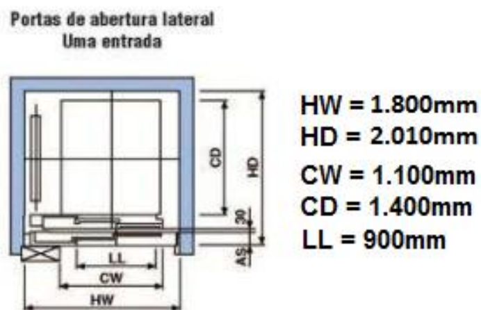
Figura 2 – Croqui em corte da caixa de corrida do elevador sugerindo posicionamento de componentes e estabelecendo requisitos dimensionais em sua seção transversal
